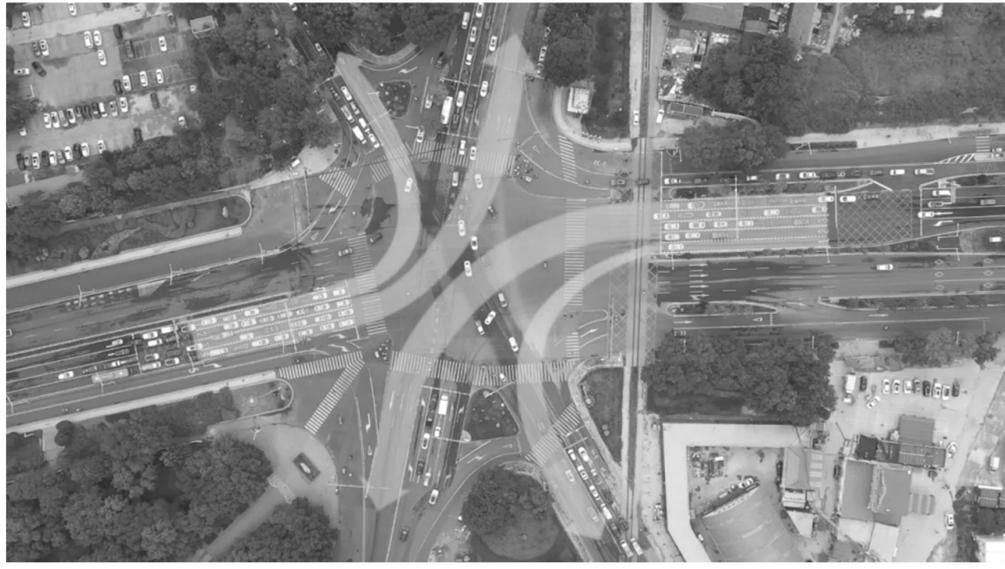
左转通行时,可变车道区最左侧车道为进入建国路方向左转车道,其余三条为进入三丰路方向左转车道。
