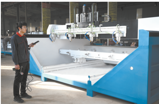
质检员正在对一台即将出厂的石雕数控机床进行调试验收。
