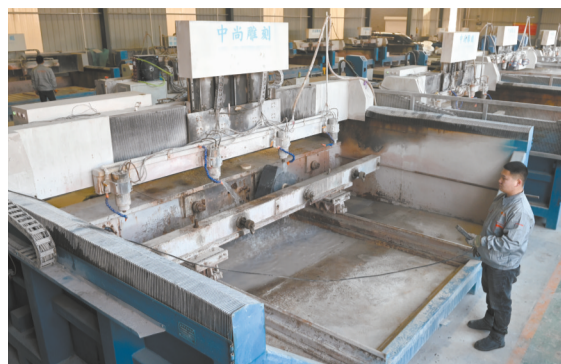
曲阳县中尚园林雕塑工程有限公司机雕车间内,数控机床正在按各自数字模型路径进行精准雕刻。
